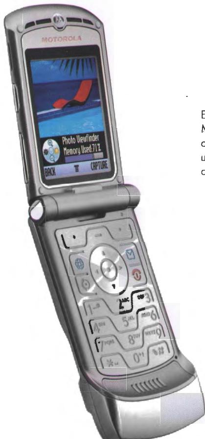
Еще одна культовая «раскладушка» компании Motorola — Motorola RAZR. Клавиатура в RAZR стала своеобразным фирменным знаком аппарата: традиционные клавиши в ней заменила тонкая металлическая пластина.
