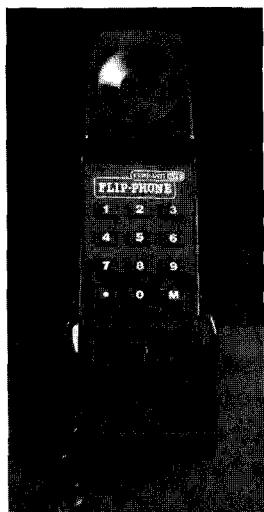
открыв его, пользователь совершал действие, аналогичное тому, когда снимает трубку с обычного аппарата, закрытие флипа в привычном понимании означало то же, что и «положить» трубку. Преимущество новой конструкции было очевидным: аппарат можно было взять с собой на диван, пристроить на кухонном столе, не опасаясь, что трубка случайно останется в «поднятом положении».
