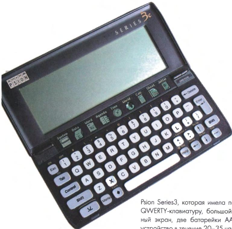
Psion Series3, которая имела полноценную QWERTY-клавиатуру, большой монохромный экран, две батарейки AA, питавшие устройство в течение 20–35 часов.
