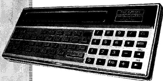
Модель была оснащена встроенными аккумуляторами, имела 1,5 Кб оперативной памяти, а также интерпретатор языка BASIC, вшитый в ROM, что позволяло создавать свои программы. Дисплей выводил в одну строку до 24 символов. В качестве аксессуара были доступны принтер, подключаемый к компьютеру, а также кассетное запоминающее устройство
